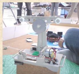
スイッチや磁気スイッチなどの回路を加えたり、駆動方法をラック式にし安定動作するための改造をしました。
