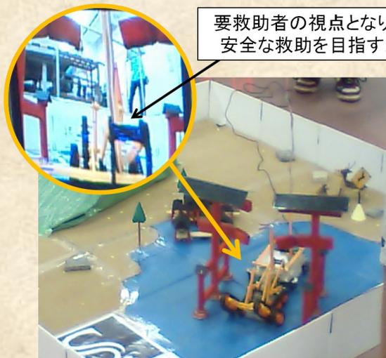
小型無線カメラを内蔵した要救助者カートを開発しました。カメラは車載用バックカメラを転用し、iPod用の映像トランスミッターで画像を送信します。小さなカートの面に多くの要素を配置し、安定稼動するまで大変な労力を必要としました。
