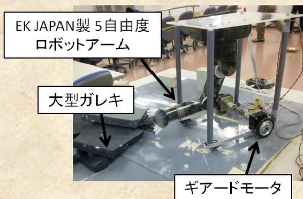
ロボットのフレームにはモーターを配置し、レスクロなどのロボットと強調した救助活動ができるよう 発展性を持たせた。またロボットは軽量であり、工具を必要とせずとも省スペースに組み立て分解できる構造としたことで 高い可搬度を持たせてある。
